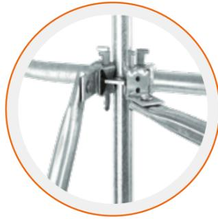
El sistema SM8 se compone de elementos verticales, los montantes, que cada 500 mm tienen soldado un nudo octogonal; éste tiene 8 foros a forma para la conexión con los otros elementos (diagonales, langueros).
